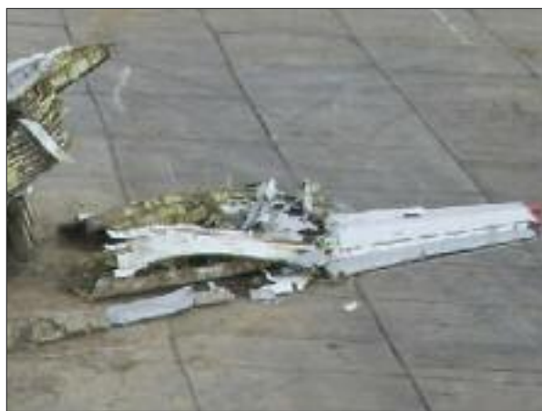
U dołu – symulacja upadku sekcji kadłuba przy V_y = -9,8 m/s. Dlaczego V_x = 0 ?
