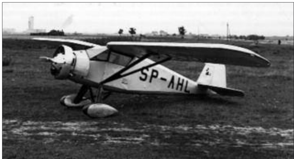
RWD-6 przebudowany na wersję bis – dodanie drugiego zastrzału wyeliminowało problem zbyt małej sztywności skrętnej skrzydeł
