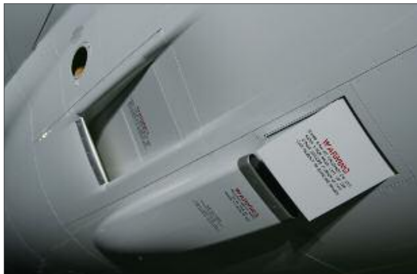
Wyróżniające Dreamlinera spośród innych liniowców wloty powietrza do klimatyzatorów
