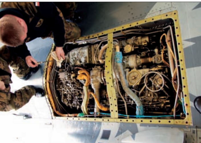
Sprawdzenie oleju silnika RD-33 przed następnym lotem
