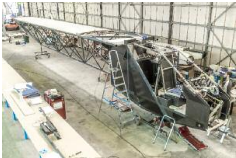
Kadłub ma konstrukcję kratownicową – również z kompozytu węglowego
