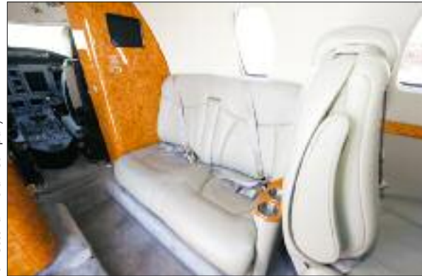
Kanapa z pasami bezpieczeństwa – dopuszczona do starów i lądowań
