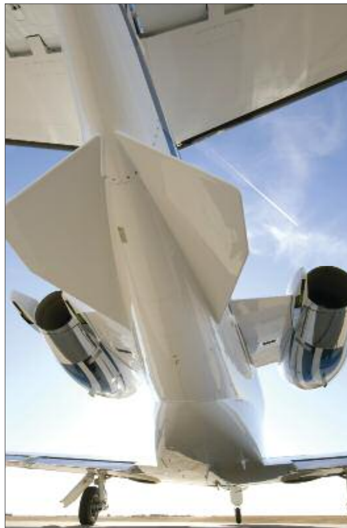
Brzechwy w tylnej części kadłuba są charakterystyczne dla modelu XLS
