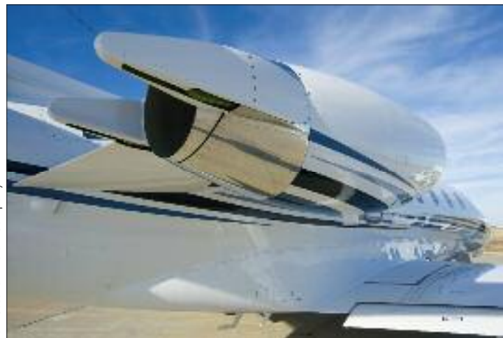
Silniki są wyposażone w odwracacze ciągu
