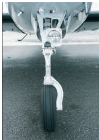
Reflektor lądowania na przedniej goleni
