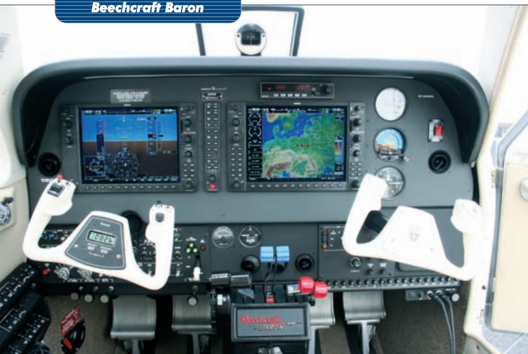
Zintegrowana awionika Garmin G1000 – dwa duże ekrany zamiast mnóstwa przyrządów
