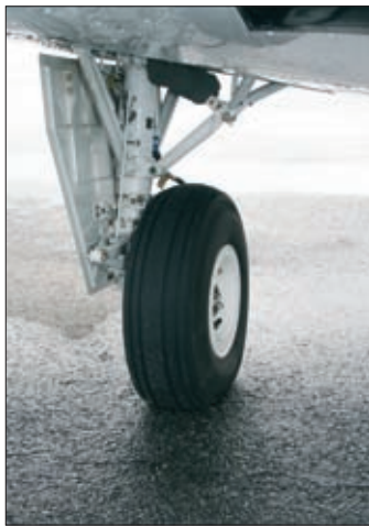
Podwozie jest chowane elektromechanicznie
