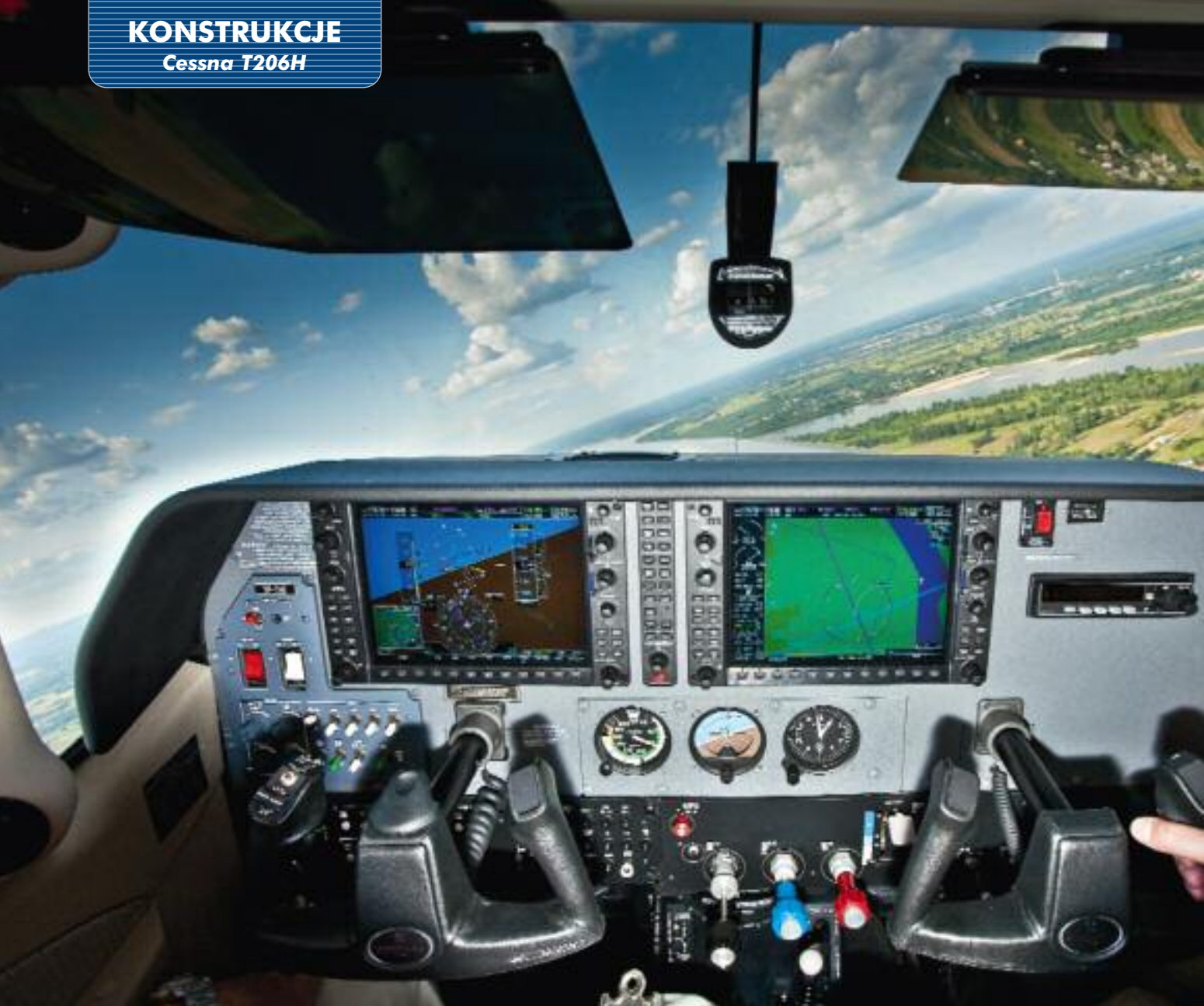
Glass cockpit w akcji: na lewym ekranie (PFD) przyrządy pilotażowe, na prawym (MFD) przyrządy silnikowe i mapa nawigacyjna. Jak widać, pilotowanie nie wymaga wysiłku.
