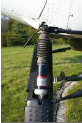
Podwozie ma skuteczną amortyzację
