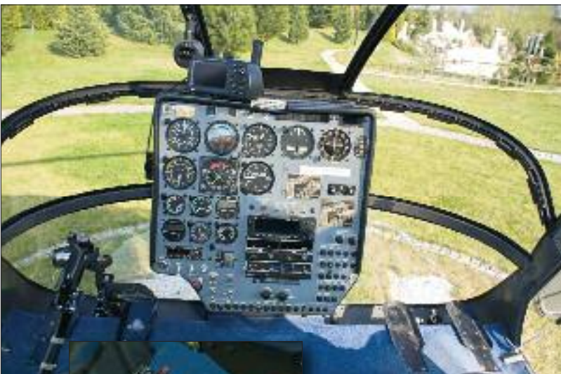
Tablica przyrządów w wersji VFR/IFR
