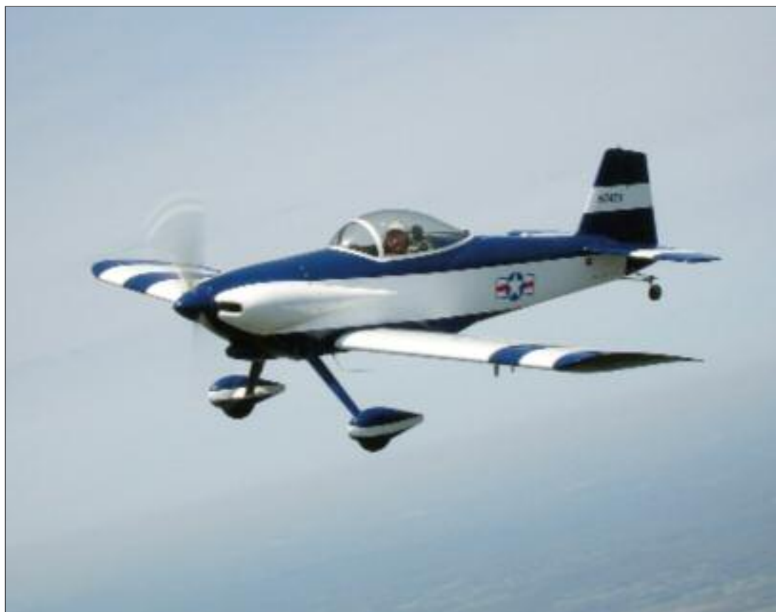
RV-3 – pierwsza całkowicie metalowa konstrukcja VanGrunsvena – stał się protoplastą bestsellerowej rodziny RV
