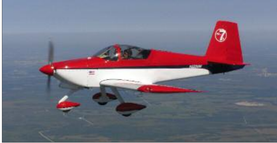
Wykorzystujący nowe technologie projektowania i produkcji RV-7A zastąpił RV-6A (litera A w nazwie oznacza kółko przednie)
