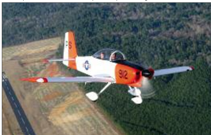
Wykorzystujący nowe technologie projektowania i produkcji RV-7A zastąpił RV-6A (litera A w nazwie oznacza kółko przednie)
