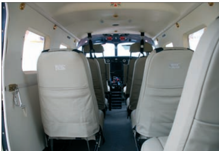
Osiem foteli pasażerskich można łatwo zdemontować, uzyskując wielką przestrzeń ładunkową
