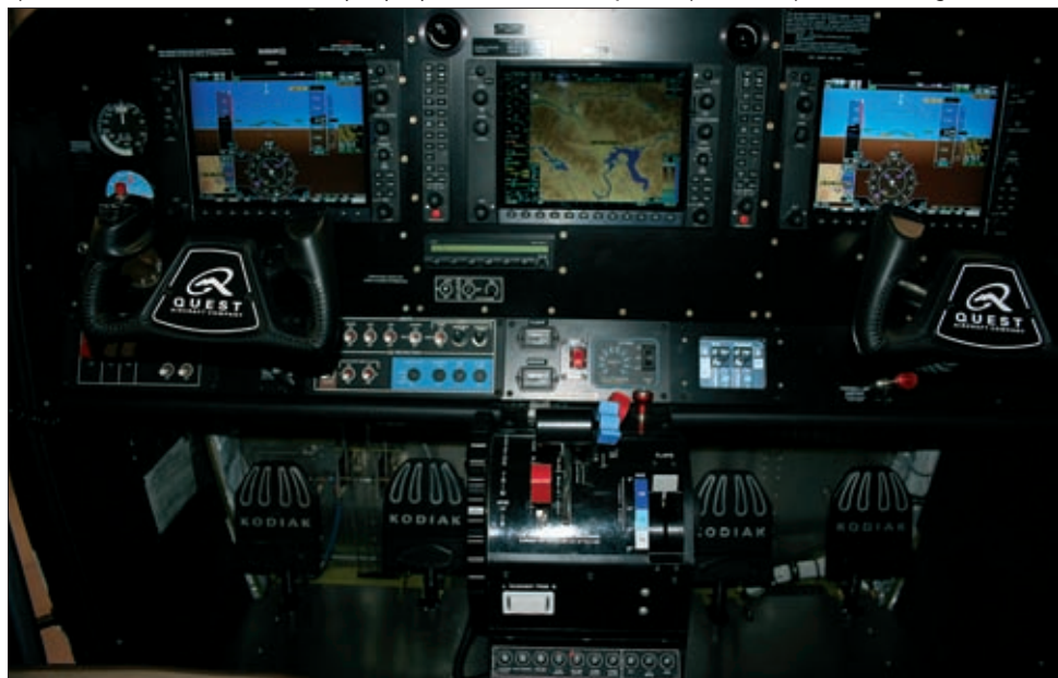
Oparta na Garminie G1000 awionika z syntetycznym zobrazowaniem zwiększa bezpieczeństwo podczas lotów w górach
