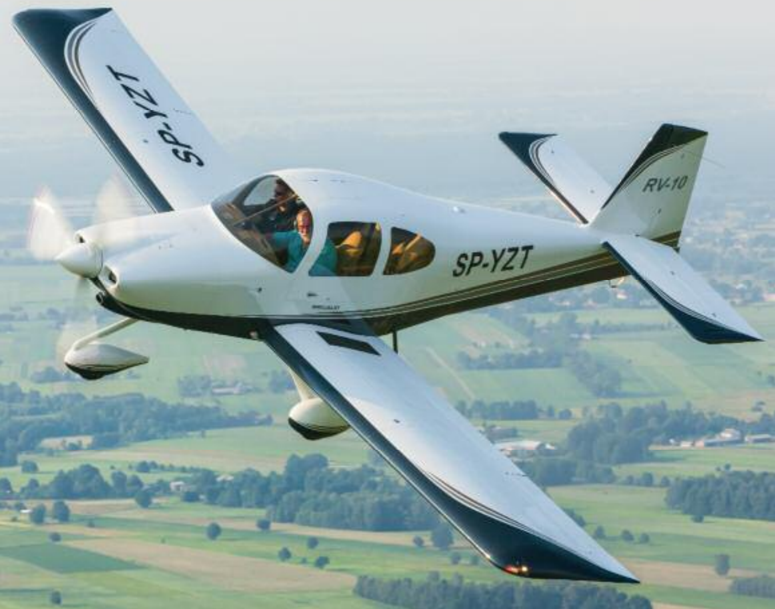
Skrzydło ma średnie wydłużenie i trapezowe końcówki, co sprzyja zmniejszeniu oporu indukowanego
