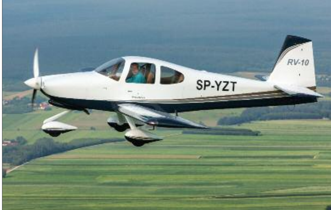
Kadłub samolotu jest wykonany z rozwijalnych powierzchni blachy, owiewka kabiny jest kompozytowa
