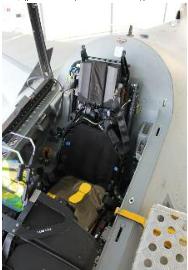
Kabinę wyposażono w fotele wyrzucane Martin Baker klasy „zero-zero”
