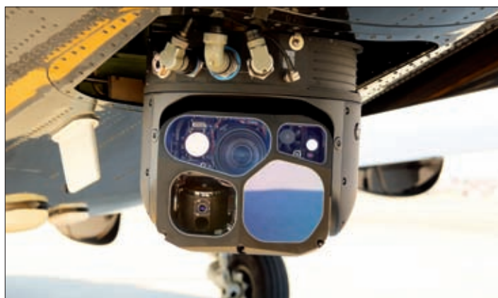
Stabilizowana głowica z zestawem kamer jest chowana podczas startu, lądowania i przelotu
