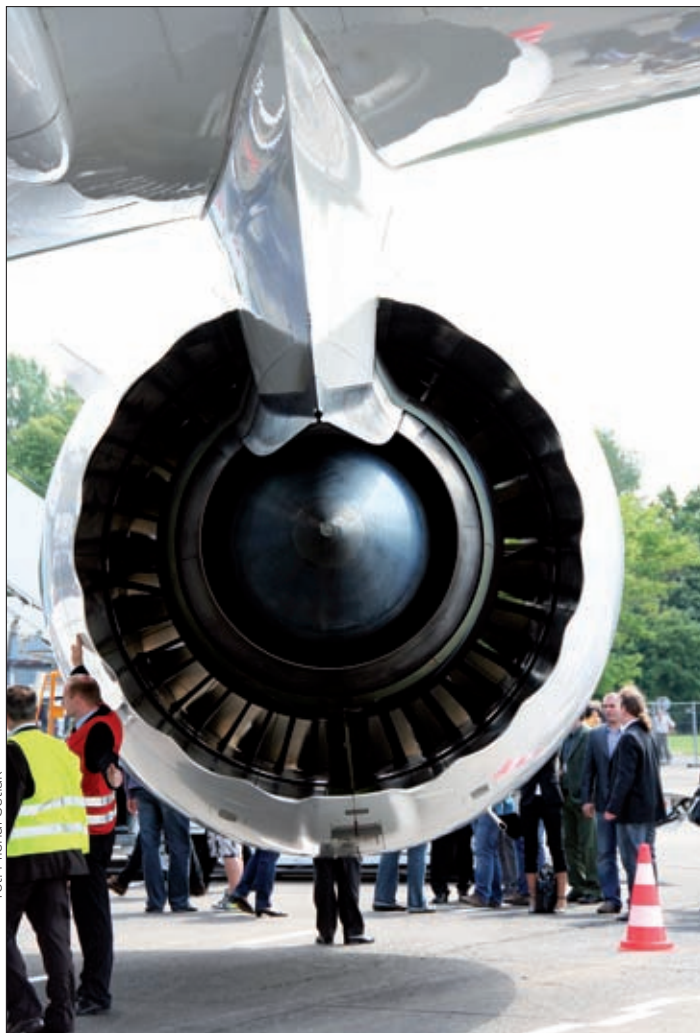
Trójwałowy silnik Rolls-Royce Trent 1000 (B787) – widoczny kanał wentylatora i wylot gazów
