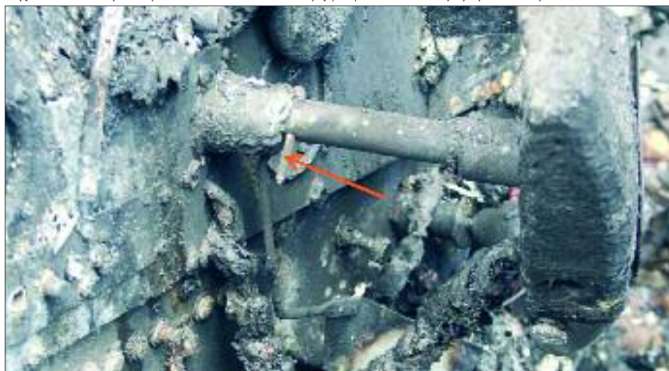
Zdjęcie wraku Cessny. Przetyczka tkwi w rurze wolantu - mylący trop w dochodzeniu przyczyn katastrofy
