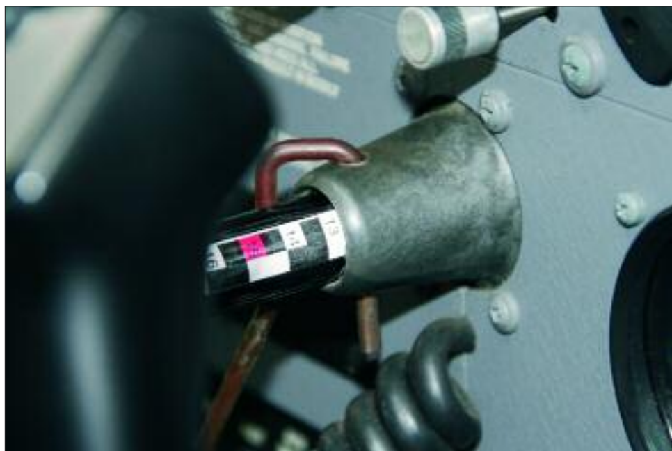
Prawidłowo założona blokada sterów przechodzi przez rurę wolantu i jej obsadę
