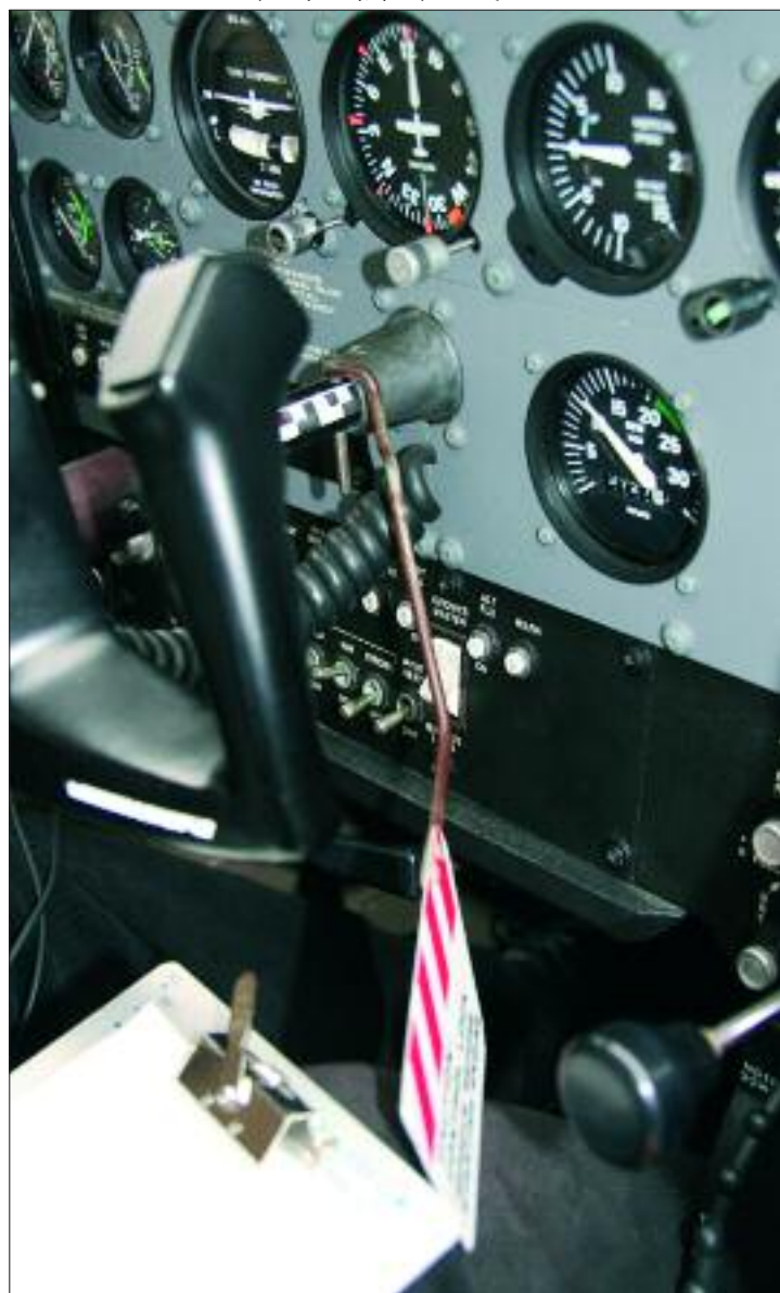
Blokada wolantu założona od prawej strony, tylko przez rurę wolantu
