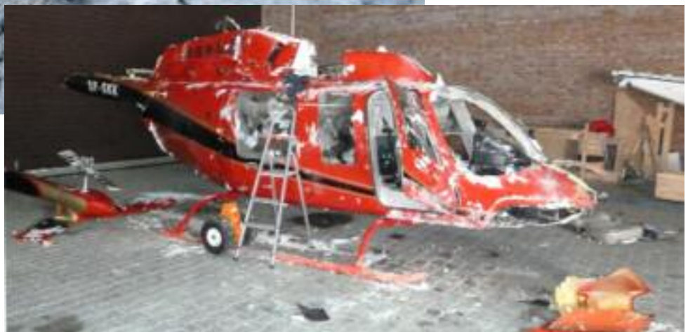
Na szczęście lot odbywał się bez pasażerów – przekładnia główna została wbita do kabiny pasażerskiej. Pilot został lekko ranny.
