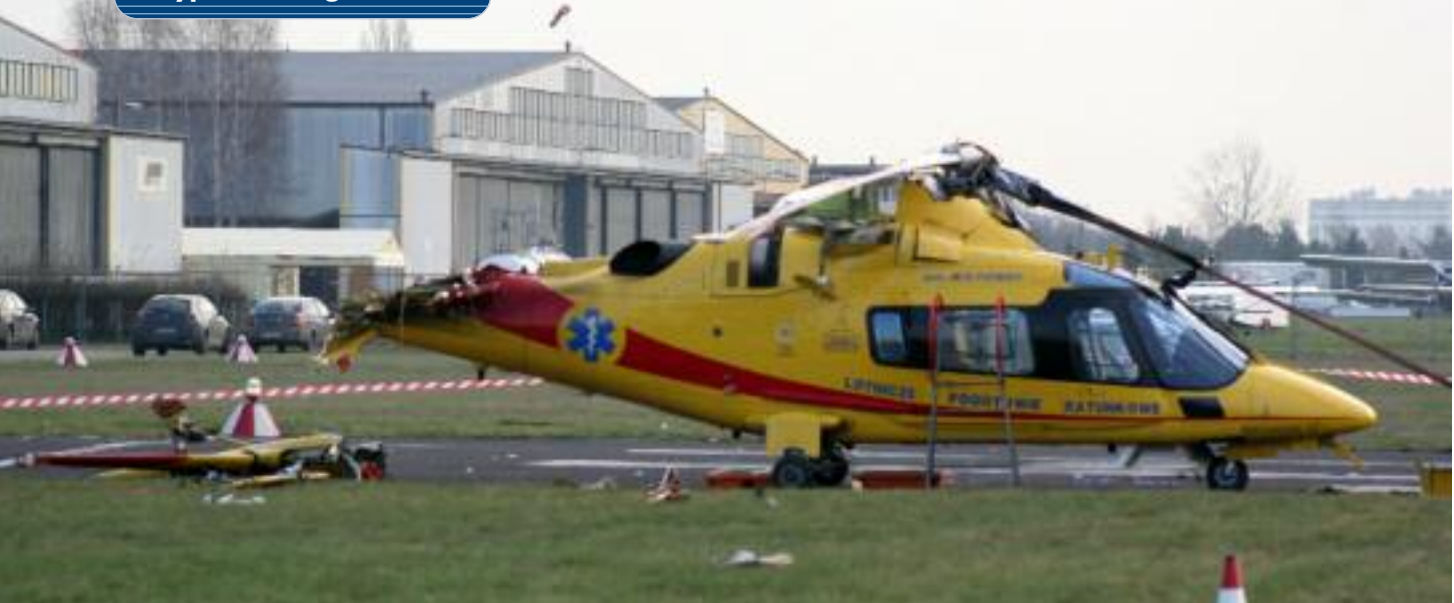
Agusta A109E zniszczona w efekcie rezonansu naziemnego – niżej widoczne narastanie oscylacji i uderzenie łopat w belkę ogona
