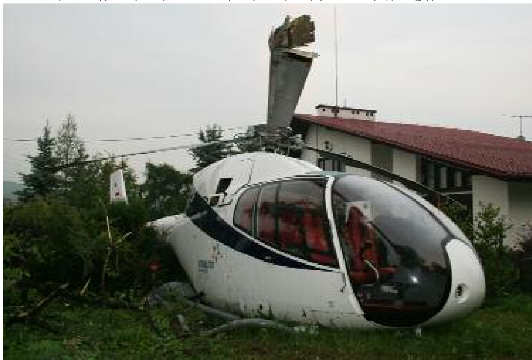
Zaabsorbowany obserwacją terenu pilot dopuścił do wzrostu przechylenia i spadku prędkości w zakręcie, przeciągając wirnik
