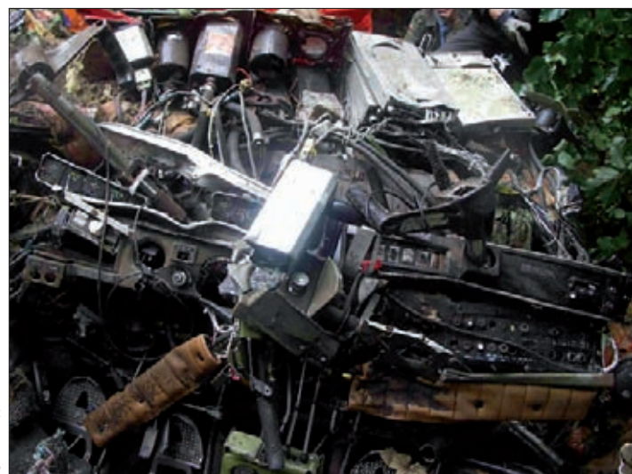
Zmiażdżona przednia część kadłuba – m.in. zgruchotana tablica przyrządów
