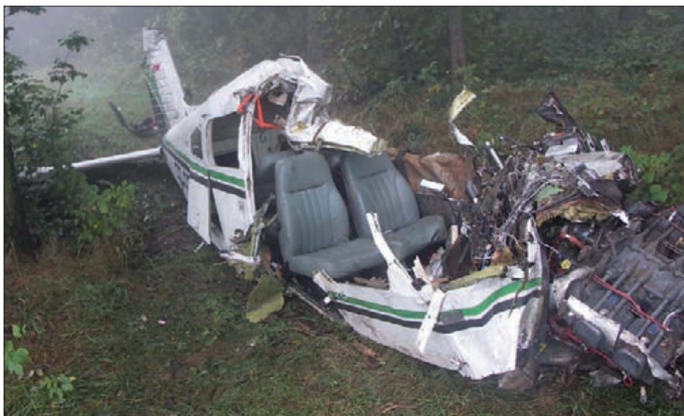
Zniszczony kadłub samolotu po obróceniu podczas badania na miejscu wypadku
