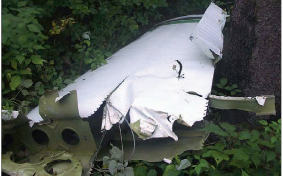
Prawe skrzydło oderwane w zderzeniu z drzewem – widoczne charakterystyczne rozdarcie blach (jak w Smoleńsku!)
