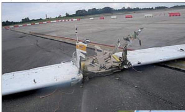
Skrzydła Cessny odpadły jako całość od rozszarpanego kadłuba
