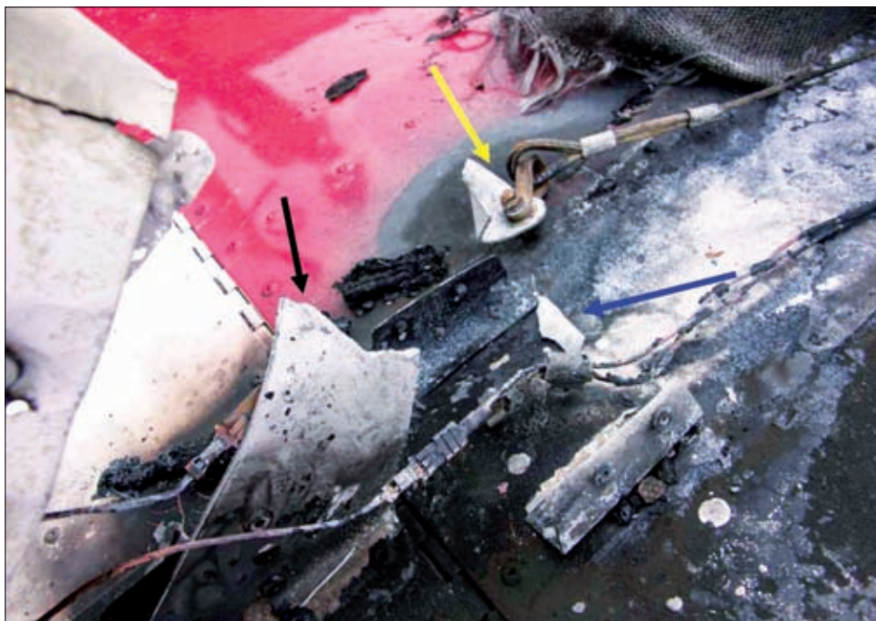
Strzałkami oznaczone są fragmenty polamanej dźwigni steru wysokości
