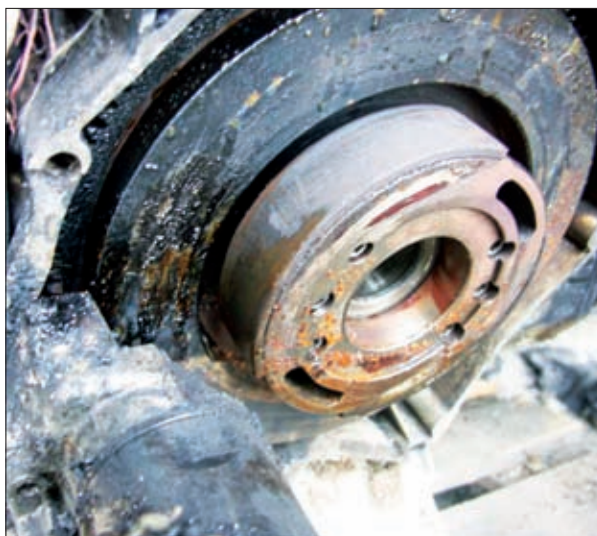
Elementy sprzęgła odśrodkowego ze śladami środka smarnego
