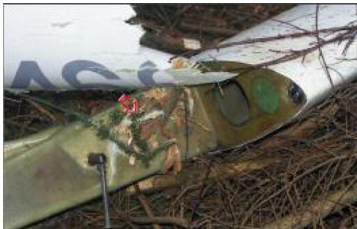
Elementy instalacji tlenowej wśród szczątków szybowca
