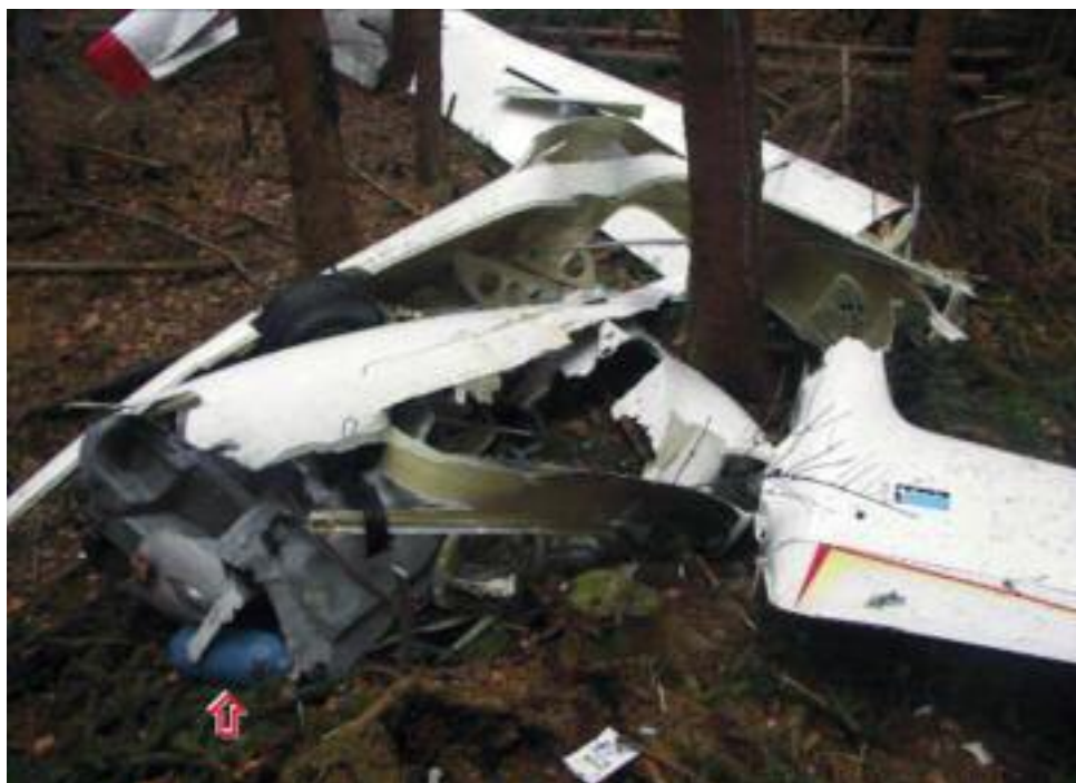
Elementy instalacji tlenowej wśród szczątków szybowca
