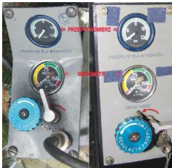
Zawór awaryjny instalacji tlenowej był w pozycji otwartej (po lewej)
