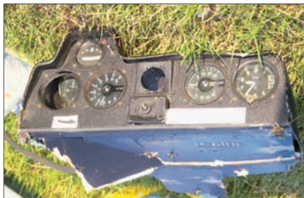
Rozbita tablica przyrządów Bociana – widoczne wskazania z chwili upadku
