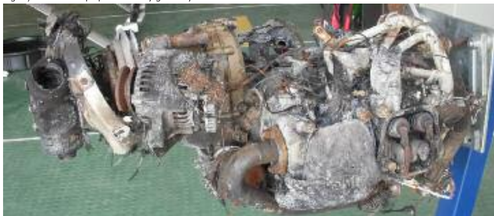
Ogólny widok silnika po pożarze i akcji gaśniczej
