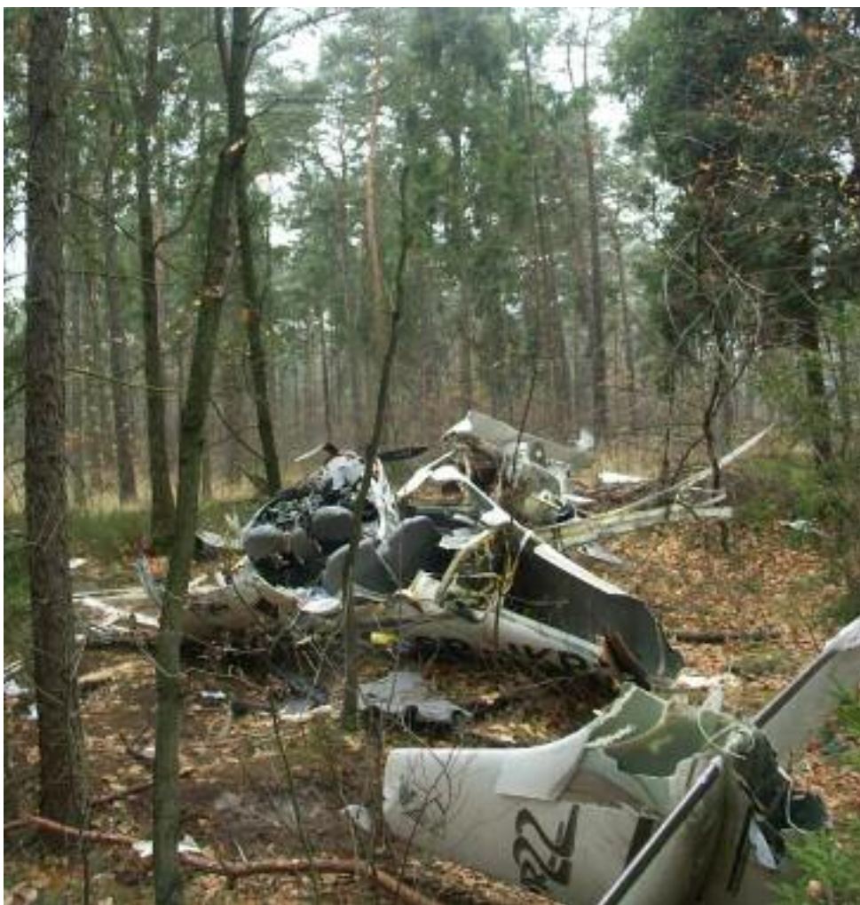
Kolizje z kolejnymi drzewami powodowały stopniowe niszczenie skrzydeł
