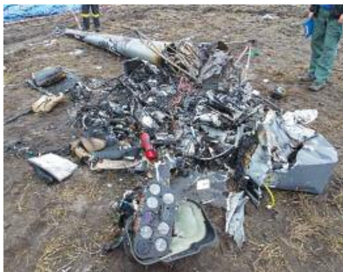
Wypalone szczątki kadłuba śmigłowca, na pierwszym planie część tablicy przyrządów
