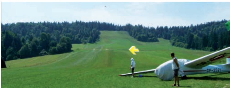
Analiza pozycji samolotu i jego cienia na amatorskim zdjęciu pozwoliła określić wysokość lotu maszyny tuż przed wypadkiem – ok. 30 m poniżej wierzchołków drzew na szczycie zbocza
