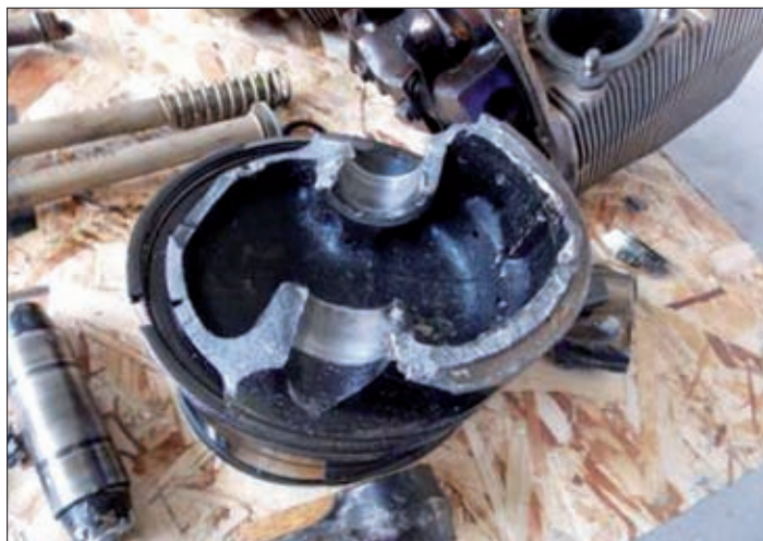
Zniszczone elementy silnika Cessny 182M G-AXNX nieobjętej polskim nadzorem
