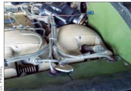
Widoczny oderwany lewy iskrownik
