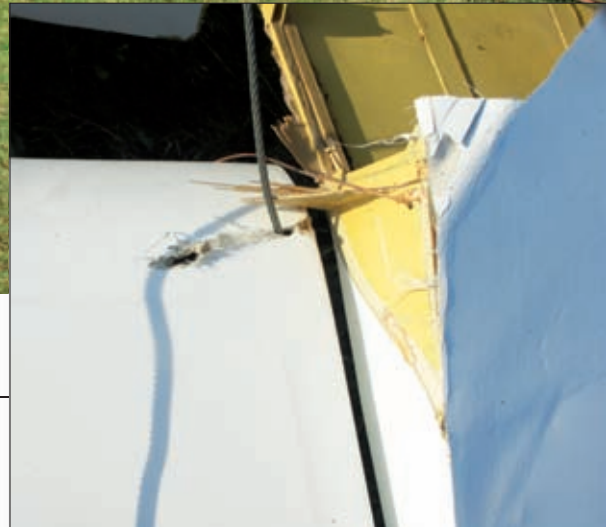
Sporządzając dokumentację fotograficzną miejsca zdarzenia, wykonujemy zdjęcia od ogółu do szczegółu – tu linka wyciągarki zaplątana wokół skrzydła i wcięta w lotkę
