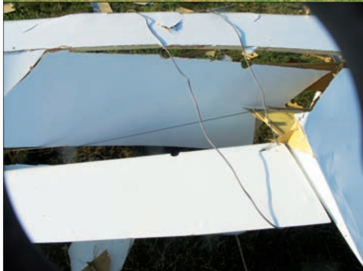
Sporządzając dokumentację fotograficzną miejsca zdarzenia, wykonujemy zdjęcia od ogółu do szczegółu – tu linka wyciągarki zaplątana wokół skrzydła i wcięta w lotkę
